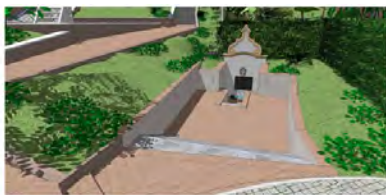
Figura 09 - Ampliar a escada de acesso ao segundo pátio ocupando a sua toda largura, corrigindo os perigosos vazios nas laterais da escada existente, além de dar maior imponência.
