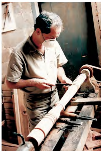
Figura 7. Torno de balaústre da escadaria interna: a arte de tornear madeiras estava relegada ao passado, atribuindo inviabilidade por seu alto valor. Bastou aquisição da máquina e a presença de um técnico municipal, saudosos de seu antigo fazer. Foto do Autor, 2000.
