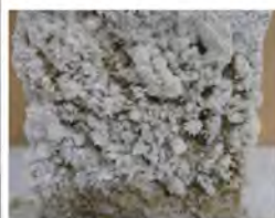
Figura 9 – Estudo de resistência aos sais de argamassas antigas (créditos: Alice Tavares)
